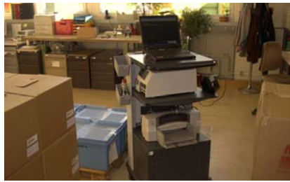
Hilfe beim Entladen: Der mobile Kommissionierwagen kann überall eingesetzt werden und verkürzt die Wege für die Mitarbeiter.
