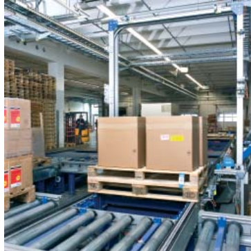
Automatischer Weitertransport in das Hochregallager
